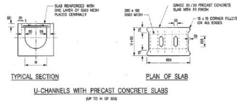
確定沿工地外圍以混凝土建造的**300毫米地面U型排水渠**足以攔截流經申請地點及在申請地點產生的雨水（圖1）。截獲的雨水將經申請地點南面擬建的**300毫米地面U型排水渠**排入現有的公共排水渠。（圖1）
