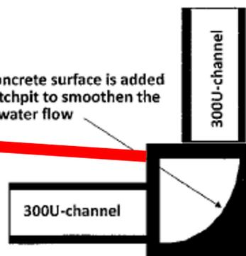
擬建的 300 毫米表面通道具有足夠的容量來處理目標地點和外部集水區產生的地面徑流。擬在終點站集水坑處設置沙坑。所有擬議的排水設施，包括擬議在目標地塊至明渠之間的一段地面渠道，均由申請人自行承擔費用提供和維護。此外，表面U型槽將定期清潔避免垃圾/碎片的堆積影響雨水的消散。
